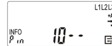
Zur Eingabe der PIN leuchten Sie auf die optische Taste. Nach dem Displaytest (Anzeigeelemente in erste und zweite Zeile werden wechselhaft eingeblendet) erfolgt die PIN-Abfrage.
