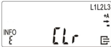
Um den Verbrauch innerhalb eines selbst gewählten Zeitraums zu ermitteln, schalten Sie mit der Taschenlampe die Anzeige solange weiter, bis in der „INFO-Zeile“ **E Clr** angezeigt wird. Leuchten Sie dann mit der Taschenlampe min. 5 Sekunden auf die optische Taste, bis die „INFO-Zeile“ **E Clr on** angezeigt wird. Ein weiteres Anleuchten für min. 5 Sekunden startet dann den gewählten Zeitraum.
